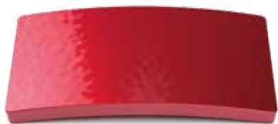
Powierzchnia pomalowana metodą natryskową
